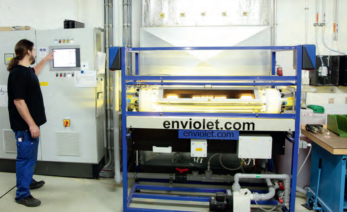
Von Licht umflutet – Abwasserreinigung durch Unterstützung von ultraviolettem Licht.
